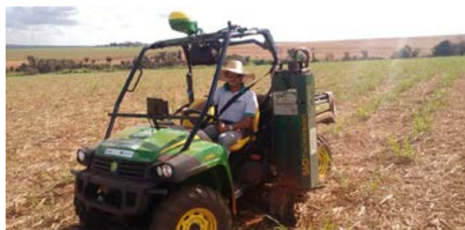
Gator utiliza sonda fixa, monitor e GPS para coleta das amostras
