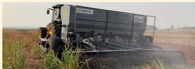
Figura 2. Subsolador utilizado para distribuição de óxido de Ca e Mg em profundidade contendo reservatório específico para o corretivo e injeção por fluxo de ar (turbina) - foto: Gaspar Henrique Korndörfer
